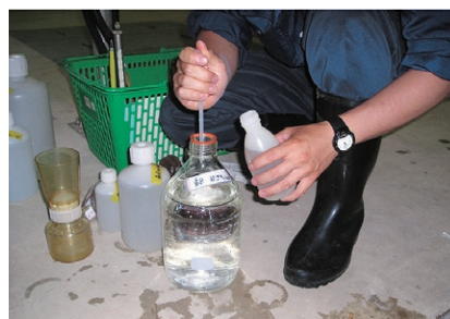
工場排水試料の現地処理
