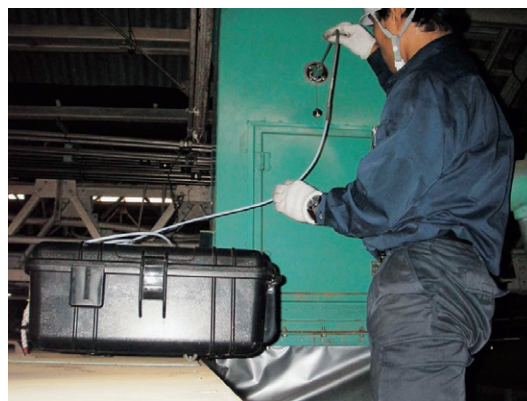
排出口におけるVOC測定
