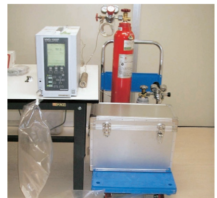
VOC濃度測定器 (FID方式)
