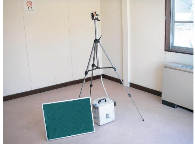
アスベスト粉じん濃度測定・試料採取
