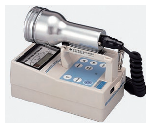
GM 計数管式 日立アロカ TGS-146B
