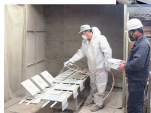
塗装作業場における現地サンプリング
