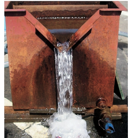
井戸の揚水試験
