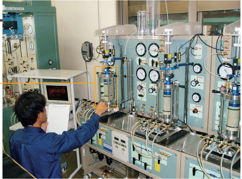
三軸圧縮試験状況
