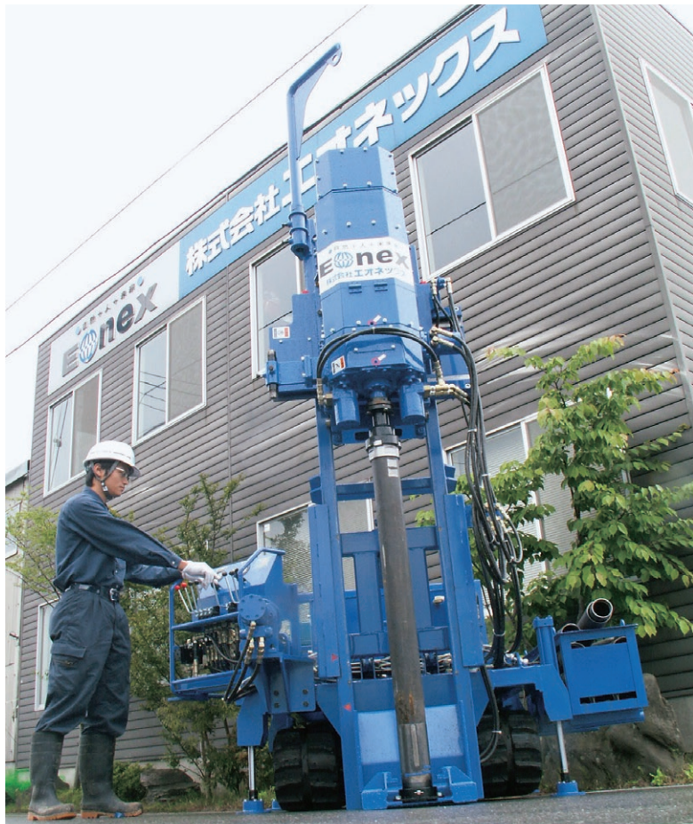
二重管式貫入型 土壌汚染調査用マシン (gaia)
