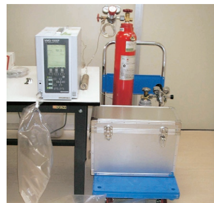
VOC濃度測定器 (FID方式)
