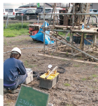
孔内水平載荷試験状況
