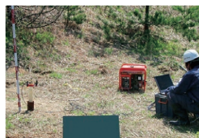
流向流速測定状況
