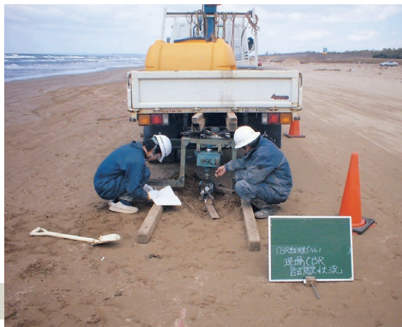
現場CBR試験の状況
