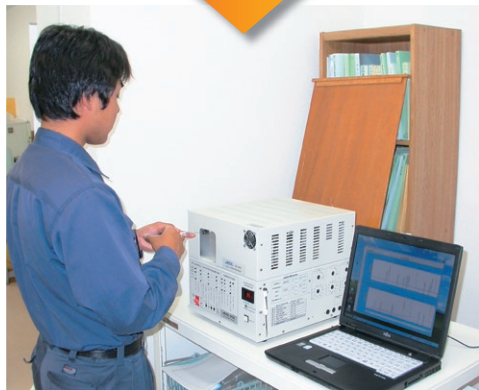
分析機器（ポータブルGC/MS）による土壤ガス分析
