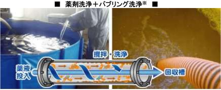
※洗浄液中にエアを噴出させて液を撹拌し、洗浄効果を上げる方法。
