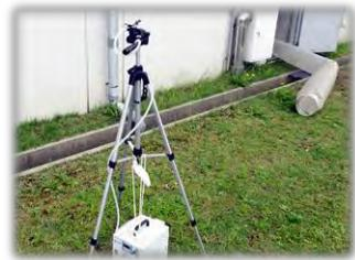
建築改修工事監理指針による処理作業におけるアスベスト粉じん濃度測定の区分
